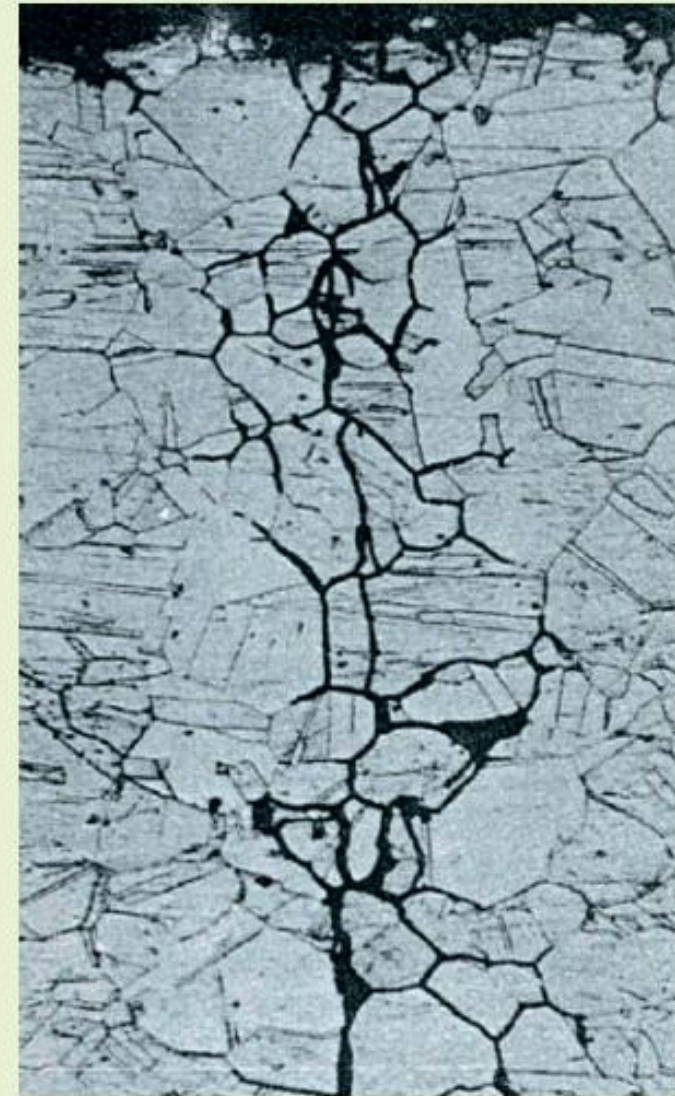
Fig. 42. Faciès de corrosion sous contrainte de l' alliage 600* présenté au 3 e congrès de métallurgie (Saclay, 1959) et observé après 90 jours en eau « pure » à 350 °C (X250).
