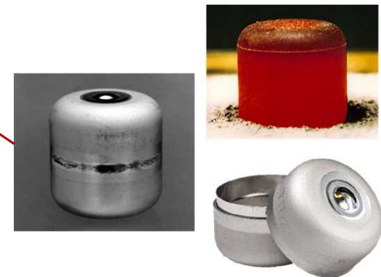
Capsule combustible, renfermant une pastille de ^{238}\text{PuO}_2 dans une gaine en alliage d'iridium
