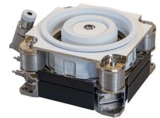
PPS® 5000 : 300 mN EP : ~18 500 m/s à 5 kWe (Safran)
